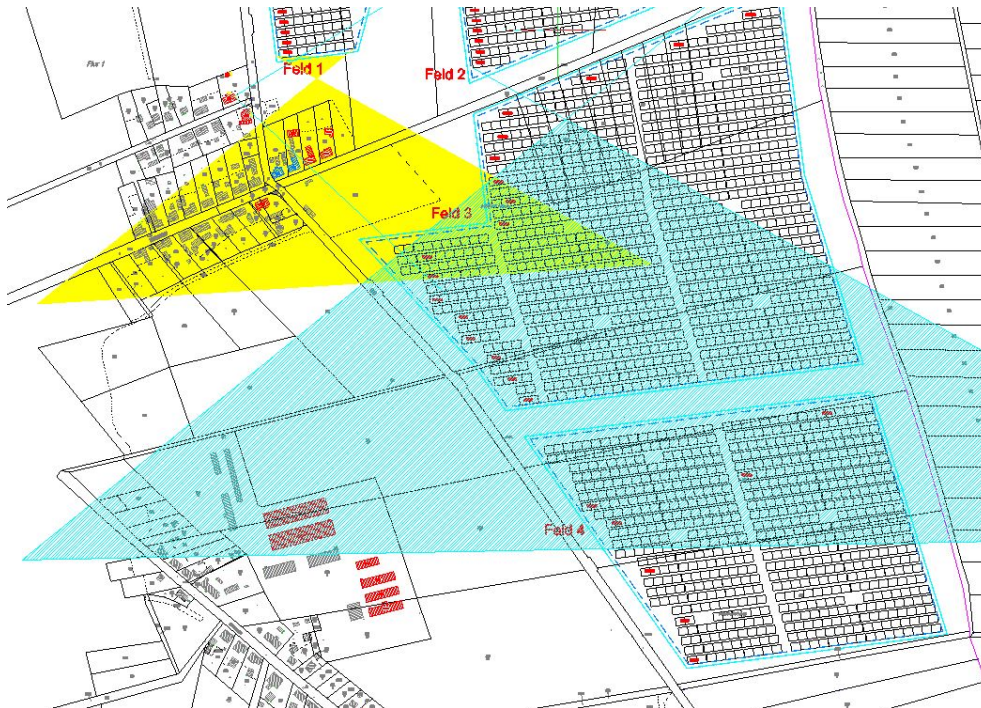
Abbildung 26: markierte Bereiche in denen keine bodennahen Reflexionen mit Höhenwinkeln unter 12° auftreten
